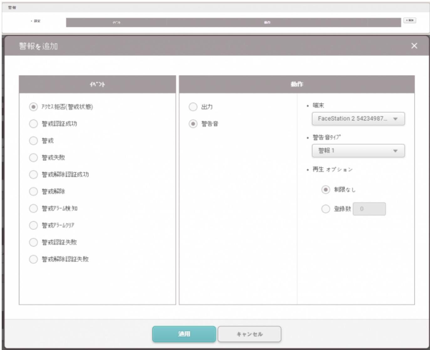
警報イベント発生後**警告音(Alert Sound)**を止めるには、**モニタリング(MONITORING)** > **端末状態(Device Status)**メニューから**アラーム解除(Clear Alarm)**を選択してください。
