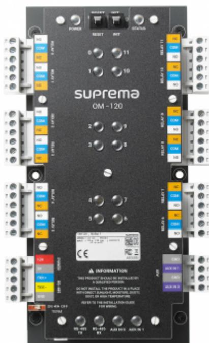
OM-120は12リレー出力制御モジュールです。 BioStar 2と一緒に使用すると、エレベータから選択したフロアへのアクセスを制御できます。
