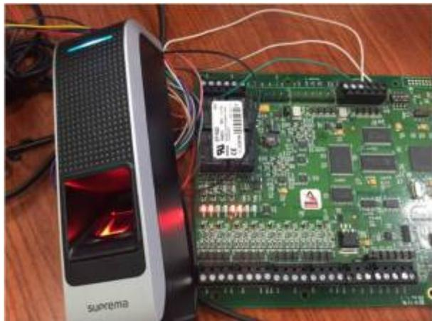
8. 他社システムのモニタリングおよび入力値を確認します。イベントや応答がなければ、配線およびパルスとWiegand形式を確認します。エラーメッセージが表示されたら、バイト順序などカードIDの形式および読み込みモードを変更してください。
