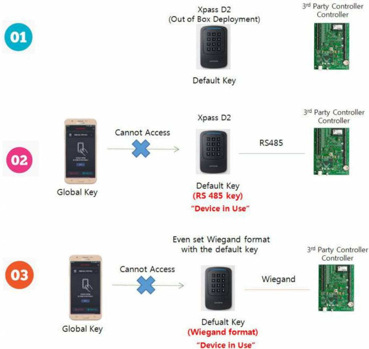
基本キーを戻すためには、デバイスの裏面にあるReset ボタンを4回連続で押し、工場初期化を行う必要があります。すると、デバイスに設定されたすべての接続が解除され、基本キーの値を持つようになります。セキュリティ面では、デバイスの接続が切断されタンパーイベントが発生するようになるので、管理者は状況を確認し、必要な措置を取ることができるようになります。
