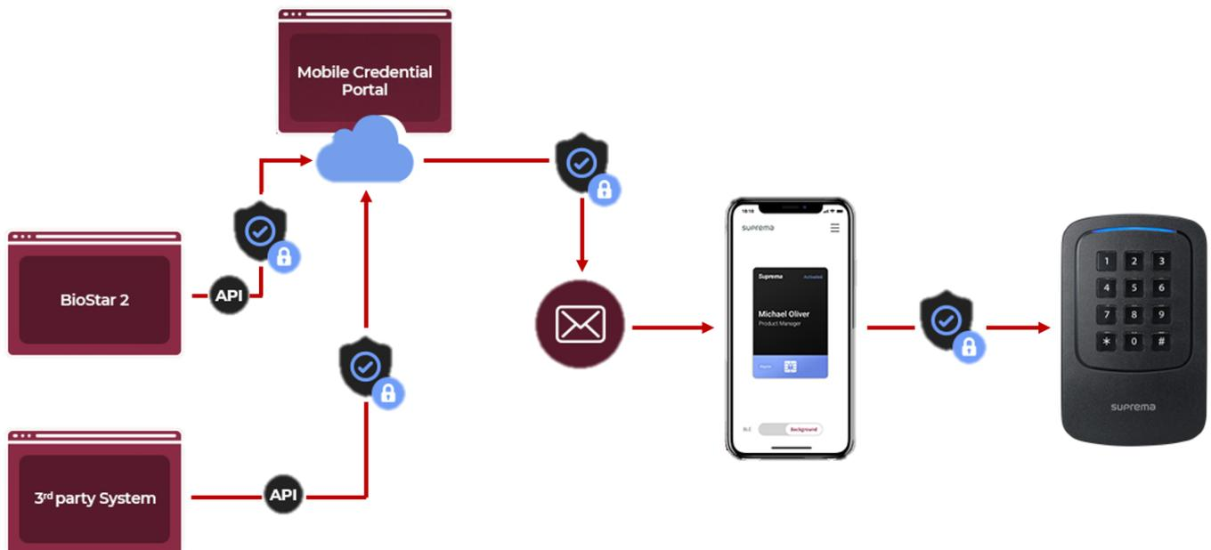
[Flujo de datos de la Credencial Móvil de Suprema de BioStar 2 SW a un dispositivo]
