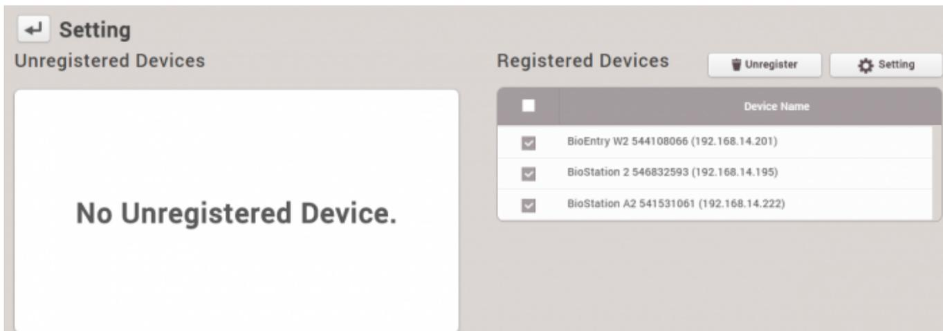
登録されたデバイス(Registered Devices)リストにデバイスが表示されます。
